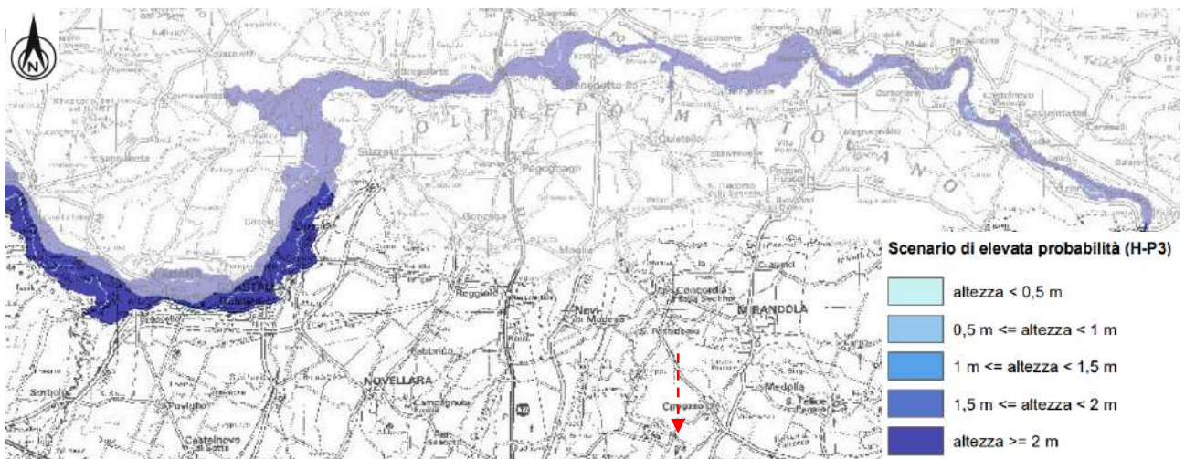
Figura 31: Carta delle APSFR arginate di rango distrettuale – ITN008_ITBABD_APSFR_2019_RP_FD001 Fiume Po da Torino al mare – Mappa dei tiranti idrici per scenario P3 (Elevata probabilità).
