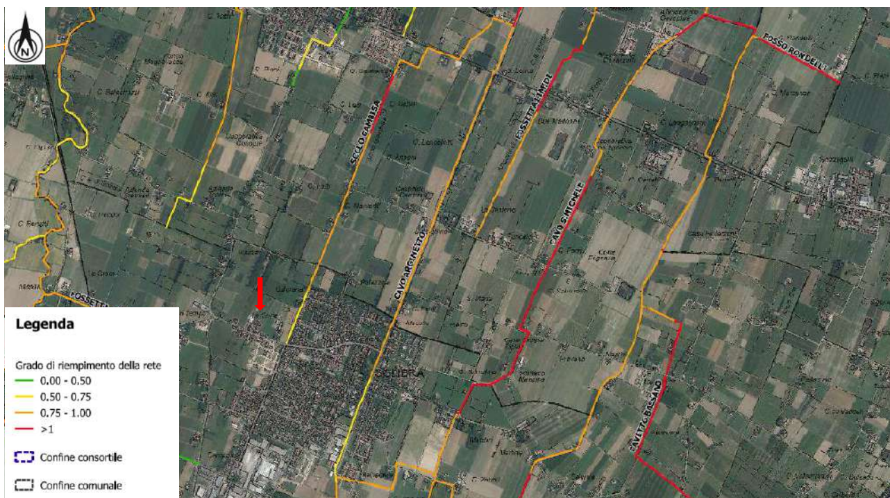
Figura 16: Estratto Modellazione idrologiche e idrauliche. Tratti critici del reticolo secondario. Tempo di ritorno 25 anni.
